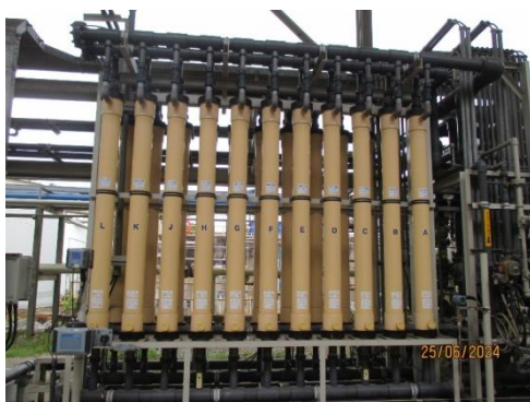
รูปที่ 3-15 ระบบกรองโคโยซีเยื่อเมมเบรน (Ultrafiltration)
